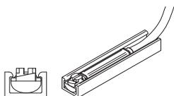
Verificare che il sensore sia correttamente inserito nella cava. Sistemare il sensore nella posizione di rilevamento desiderata.
