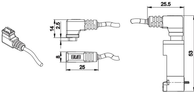
connettore singolo con cavo 0,3-0,5 m
