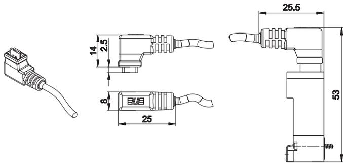
connettore singolo con cavo 0,3-0,5 m
