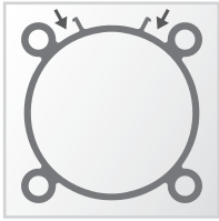
Profilo del tubo con cave sensore integrate originale UNIVER dal 2005
